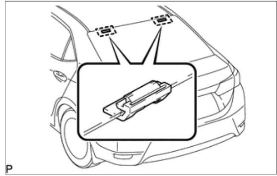
a. Установите 2 новых фиксатора заднего стекла № 1 на кузов автомобиля, как показано на рисунке.
